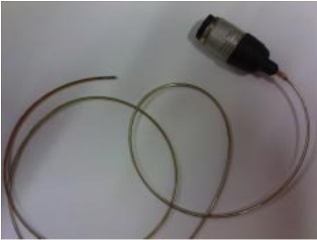
Figuur 1. De rectale drukmeter. De sensor is zo klein dat ze nauwelijks te onderscheiden is van de geleidedraad.
